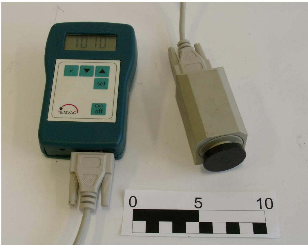
Abbildung 5.11: Der verwendete Pirani-Drucksensor inklusive des angeschlossenen Anzeigergerätes.
